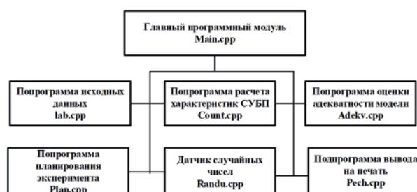
Рисунок 5 – Блок-схема программы расчета характеристик системы безопасности полетов
