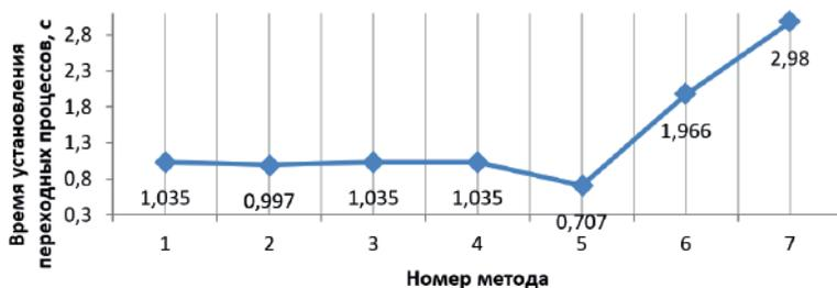
Рисунок 3 – График времени установления переходных процессов с применением различных методик расчета коэффициентов для построения ПИД-регулятора
