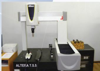
5. **3d-сканер Nikon Altera 7.5.5 с LC15 Dx.** Координатно-измерительная машина премиум-класса серии ALTERA, с лазерным сканированием сложных криволинейных поверхностей. Точность сканирования достигается до 1,8 мкм за счёт керамической конструкции с почти идеальной удельной жёсткостью и большой устойчивостью к изменениям температуры, гарантирующая исключительные и стабильные результаты в любых производственных условиях.
