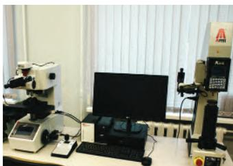
9. **Твердомер аналоговый AFFRI-URBV-V.** Предназначен для измерения твердости металлов и сплавов, пластиков, мягкой и твердой резины по стандартизованном шкалам твердости Роквелла (HRA, HRB, HRC, HRN, HRT) по ГОСТ 9013-59, Виккерса (HV) по ГОСТ 2999-75, Бринелля (HB) по ГОСТ 9012-59.
