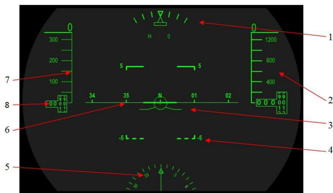
Рисунок 1 – ИЛС неманевренного самолета:
