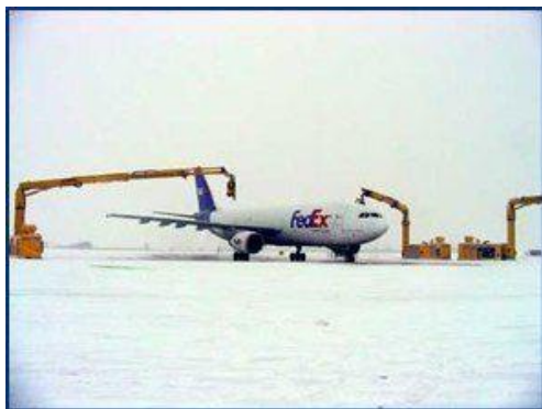
Рисунок 1 – Портальная система Ice Wolf в аэропорту Денвера
