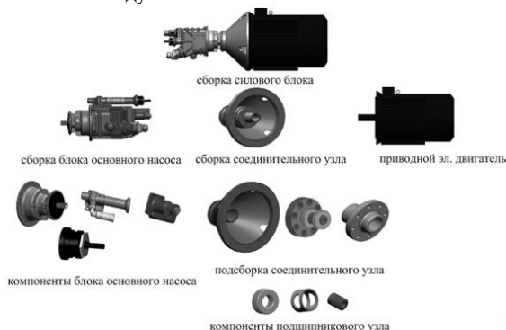
Рисунок 1 – Структура создания силового блока гидравлического модуля
