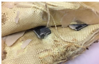
Рисунок 2 – Результат испытаний противопульной защиты структуры с углепластиком ВКУ-25
