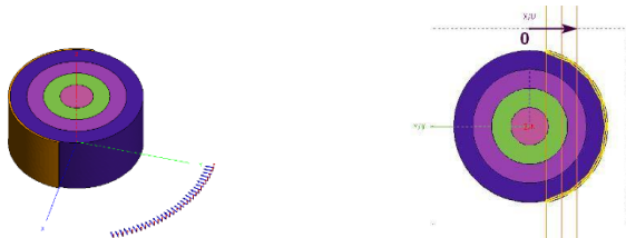
Рисунок 3 – Модель четырехслойной цилиндрической линзы Люнеберга и изменение площади металлизации смещением секущей плоскости
