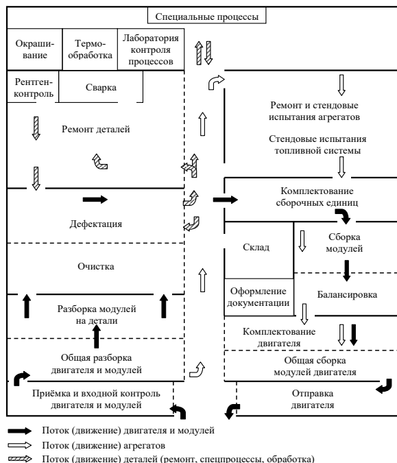
Рисунок 1 – Схема организации локализованного ремонтного производства авиационных ГТД
